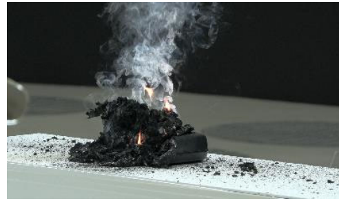
電動アシスト自転車用非純正バッテリーの発火 (再現イメージ)
