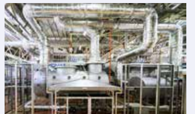
デンソー福島の水素アフターバーナー炉（出典/デンソー福島）
