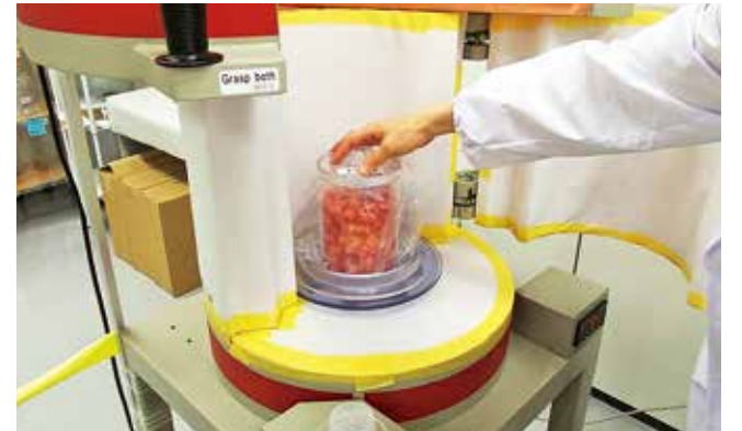
福島県産品の安全を確保 緊急時モニタリング検査（ゲルマニウム半導体検出器による測定）
