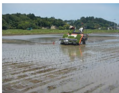
自動操舵田植え機による田植え状況 (南相馬市小高区 小高東部地区)
