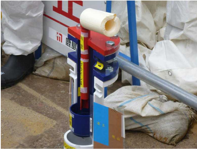
○凍土遮水壁工事の説明 に使用した凍結管の模型
