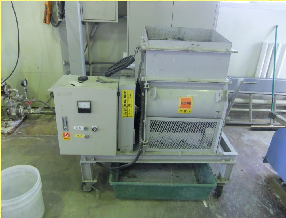
二軸式混練リミキサー(100L)
