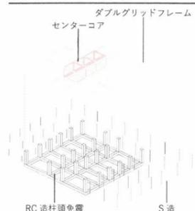
免震層より上部の階は軽量・安価な鉄骨造とし、「センターコア」と「外周のダブルグリッドフレーム」で構成します。外周部はフレームのピッチを小さくして細かい部材で構成します。この構造システムにより執務室は約15m スパンの無柱空間を経済的に確保でき、フレキシブルな平面計画が可能です。
