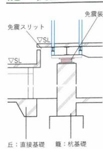
中心部の階数が多いRC+S造の「カゴ」には杭基礎を採用し、その外周の平屋の「オカ」は中心部からは独立した軽量のS造とした上で、安価な直接基礎とします。N=10前後と表層部付近で地耐力の出る土地性状を活かし、重量部と軽量部に切り分けた構造形式とすることで、構造強度と経済性の両立した計画とします。
