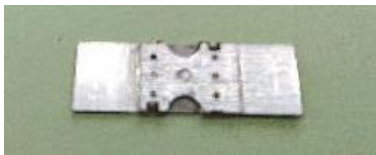
図5 インラミネート型バイパスダイオード
