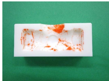
図17 口金に残った検査剤の観察画像
