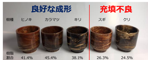
図5 各樹種の素材をおちょこ形に成形した結果
