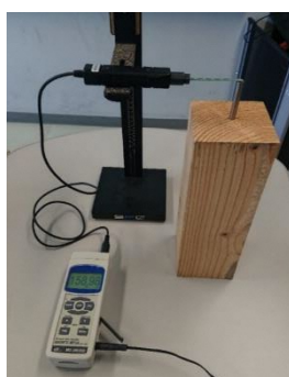
図4 ガウスメータによる磁束密度測定の様子（左図）と Elmer との結果比較（右図）
