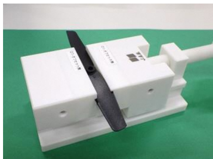
開発した手法によるドローン用プロペラの把持
